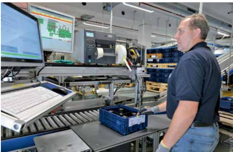
AKL-I-Punkt mit 4 Arbeitsplätzen zur Vereinzelung und Einlagerung von Kleinladungsträgern.
