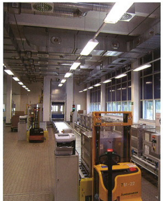
Bild 3 Das Hochregallager ist mit den verschiedenen Produktionsbetrieben über Tunnel verbunden, in denen ein Fahrerloses Transportsystem (FTS) verfährt, das die Produktion versorgt und Fertigwaren ins HRL bringt.
