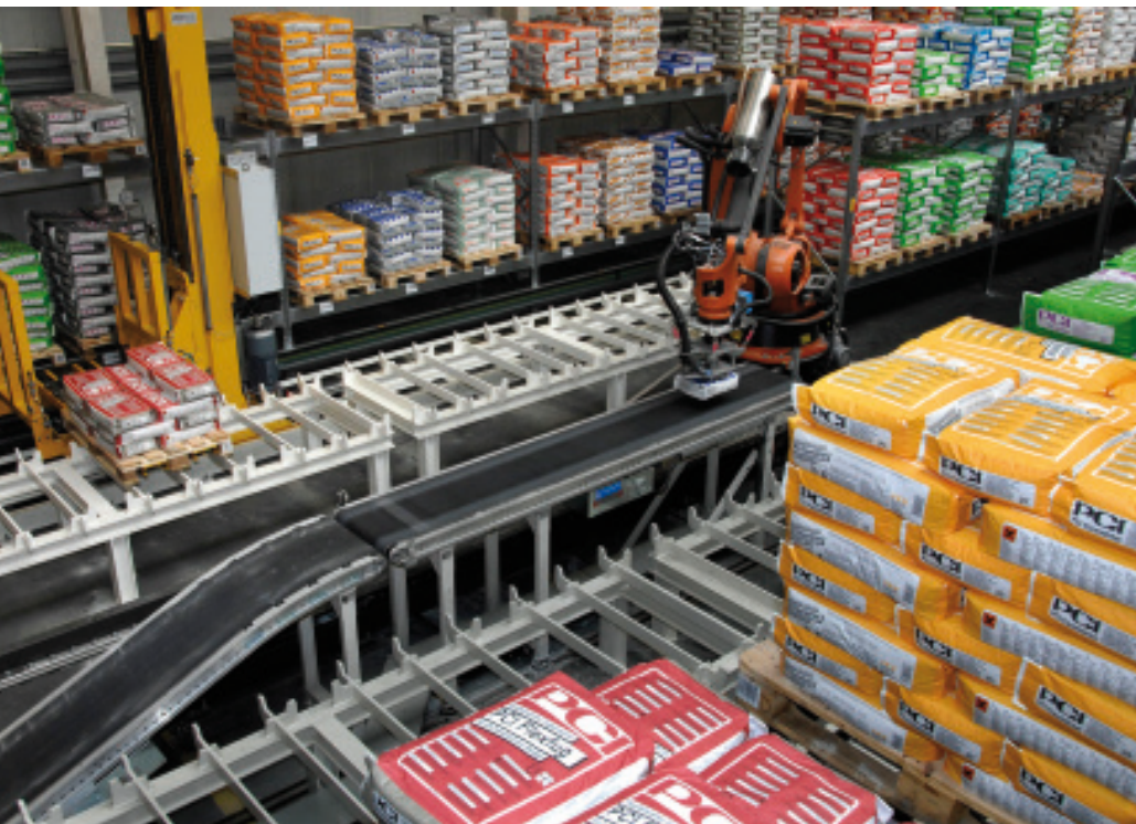
Bild 1 Durch die vollautomatische Kommissionierung per Robotersystem entlastet PCI seine Mitarbeiter von den schweren Handling-Tätigkeiten. Sackware mit einem Gewicht ab 15 kg kommissioniert der Baustoffhersteller PCI in Augsburg seit kurzem vollautomatisch per Robotersystem.
