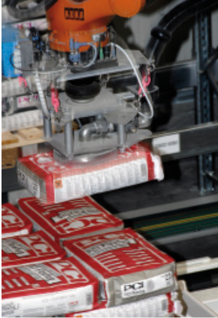
Bild 2 Der Pick-Roboter saugt die Sackware von der Lagerpalette an und hebt sie auf das Förderband.
