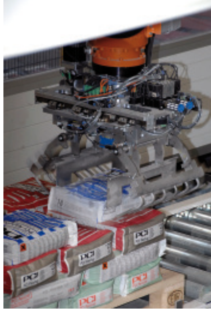
Bild 3 Der mit einem Greif-Werkzeug ausgestattete Palettier-Roboter setzt die Säcke auf die Kundenpalette.
