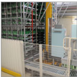
Bild 1: Das zweigassige AKL von WMF wird vierfachtief mit Tablarbelegung. Bild: IGZ Logistics + IT
