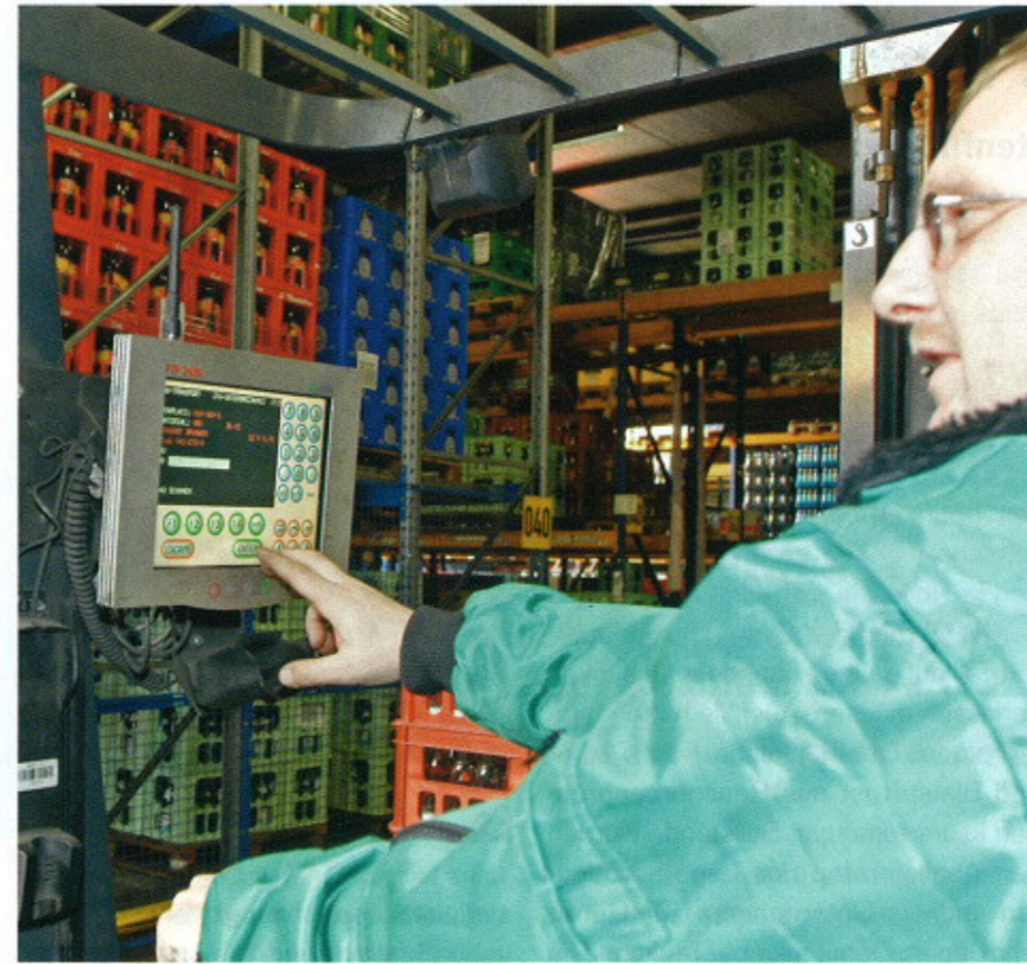
Nachschubauftrag auf einem IND-Staplerterminal
