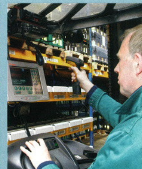
IND-Datenfunkterminal auf einem Gabelstapler
