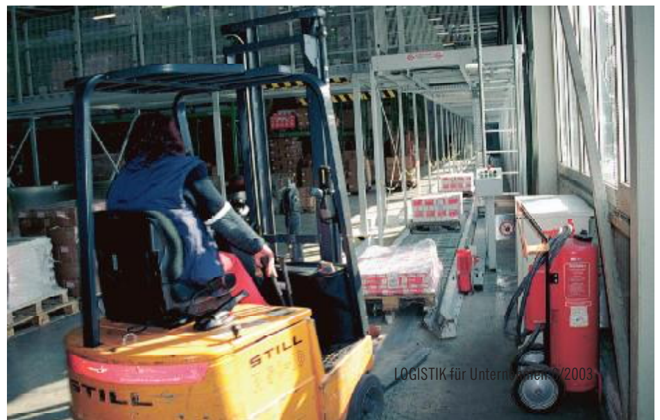
Bild 5 Blick in den Versandbereich und die fördertechnische Anbindung des Reservelagers.
