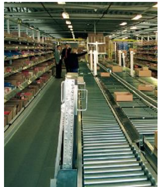
Bild 6 Blick auf die Pick-by-Light-Anlage mit Paketförderstrecke und Durchlaufregalen.
