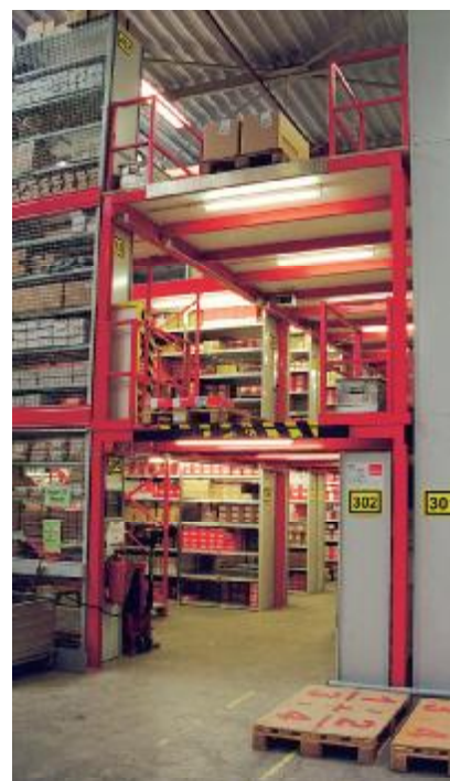
Bild 3 Die dreigeschossige Fachbodenregalanlage mit 3 900 Plätzen für kleinvolumige C- und D-Teile.
