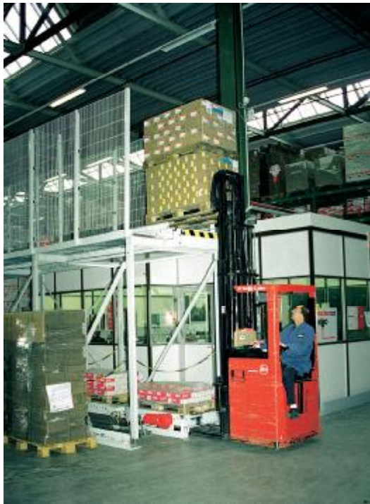
Bild 4 Per Gabelstapler wird die ausgelagerte Palette auf die zweigeschossige Palettenförderanlage zum Transport in den Versandbereich aufgegeben.
